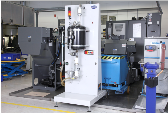
Islak çalışma koşullarında vakum üretimi için Vakum Operasyon Merkezi VOC
