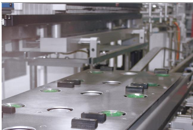
Flachsauggreifer SPF beim Einsatz in Kartonieraufrichtern
