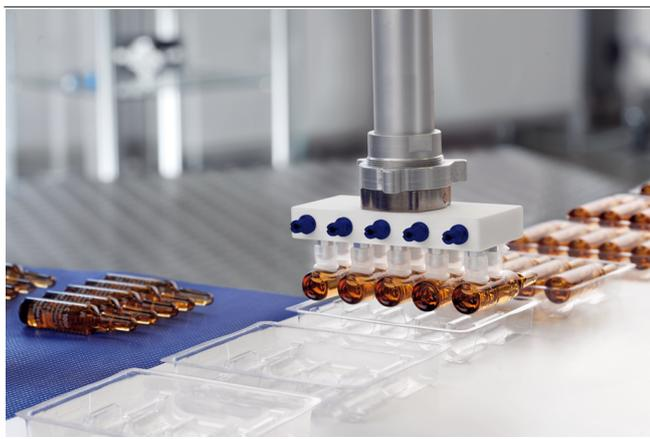
Generazione di vuoto mediante gli eiettori ecoPump SEP per la movimentazione di ampolle
