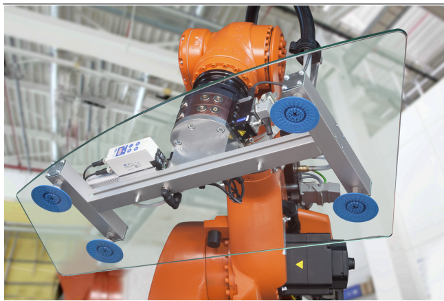
Zentrale Vakuum-Erzeugung durch Kompaktejektoren X-Pump SXPi / SXMPi
