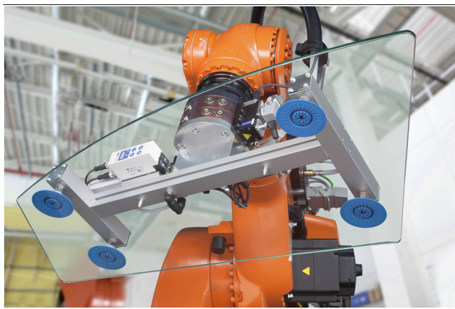
Generazione di vuoto centrale mediante gli eiettori compatti X-Pump SXPi / SXMPi
