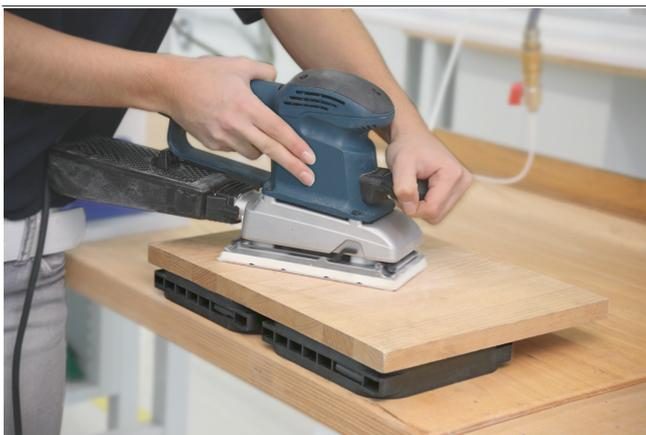
Multi-Clamp plaque de bridage VC-M-SP pour l'usinage manuel d'une pièce en bois
