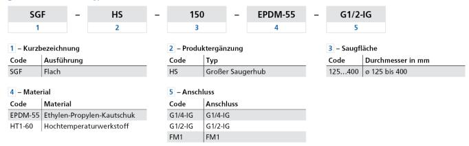
Die Saugplatte SGF (Dichtring + Trägerplatte) wird montiert geliefert. Das Produkt besteht aus:
