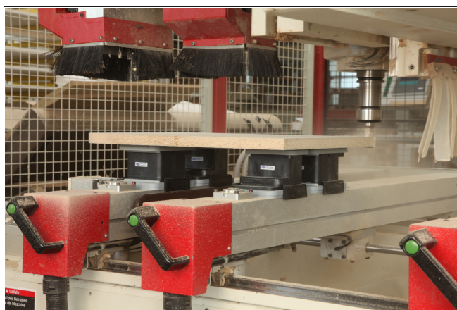
Blocchi di aspirazione VCBL-K2 durante il bloccaggio di un pezzo
