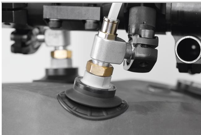
Ventose a soffietto SAB HT2 per la movimentazione di pezzi di lamiera
