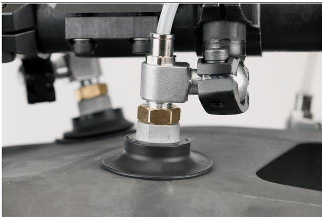
Flachsauggreifer SAF HT2 bei der Handhabung von geformten Blechen
