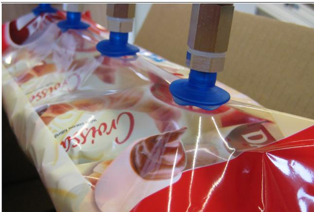
Ventose a soffietto per FGA PVC per la movimentazione di pezzi flessibili
