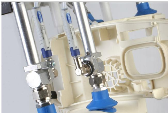
Generazione di vuoto decentralizzata mediante gli eiettori in linea SLP per la movimentazione di pezzi in plastica stampati a iniezione
