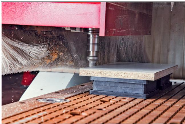
Blocksauger VCBL-R beim Aufspannen einer Spanplatte
