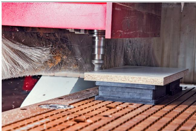
Blocchi di aspirazione VCBL-R durante il bloccaggio di pannelli in truciolato
