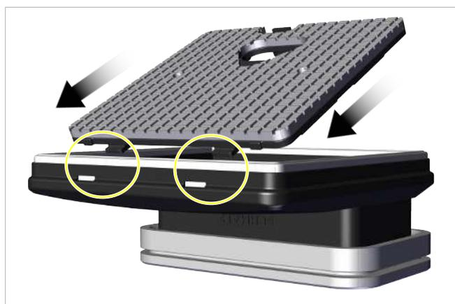
2. 将摩擦夹的锁定面压向外壳，直至听到锁定装置卡入外壳凹槽的声音。
