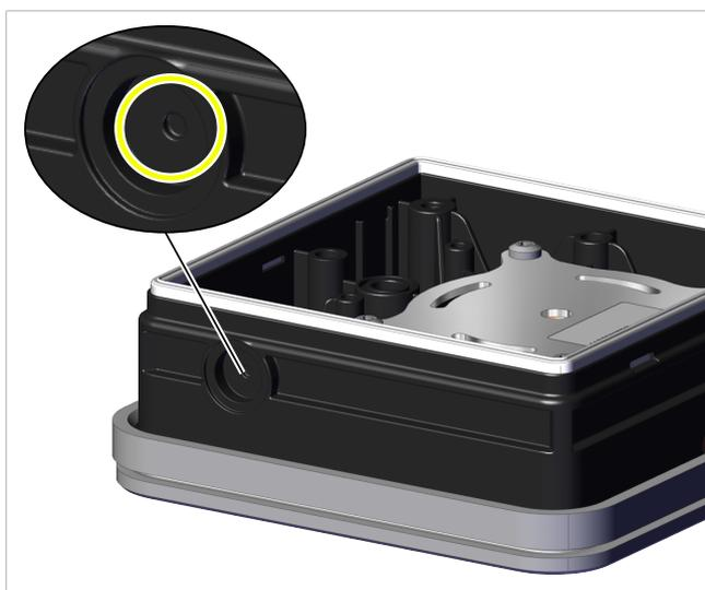
3. Montar la conexión de tubo flexible (2) (que se muestra aquí con un tapón de cierre (1)), tal como se muestra en la figura.
