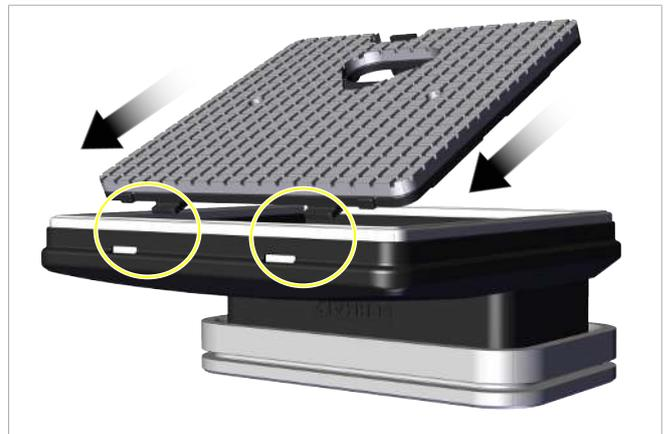
2. Den Reibclip auf der Seite der Verriegelung in Richtung des Gehäuses drücken, bis die Verriegelung hörbar in die Aussparung am Gehäuse einrastet.
