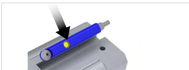
2. Mueva el sensor hasta el tope en la ranura en T o, en las variantes con **ranura en T abierta**, fije el sensor a ras con el extremo inferior de la ranura (mirando a la superficie de agarre).
