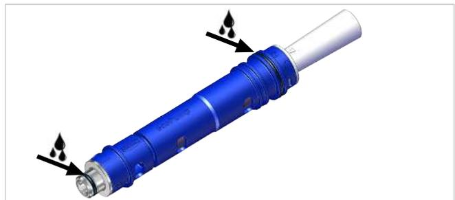
2. Deslice el módulo eyector (4) a través de la abertura, en la posición adecuada, con las aberturas de aspiración del módulo eyector (4) como se muestra, y hasta el tope.
