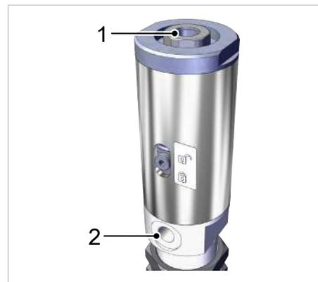
La conexión de vacío (1) sirve para el suministro de vacío de la ventosa conectada al eje de la biela elástica. Presenta las dimensiones RI G1/8". Las dimensiones del tubo flexible de vacío dependen de la ventosa utilizada.
