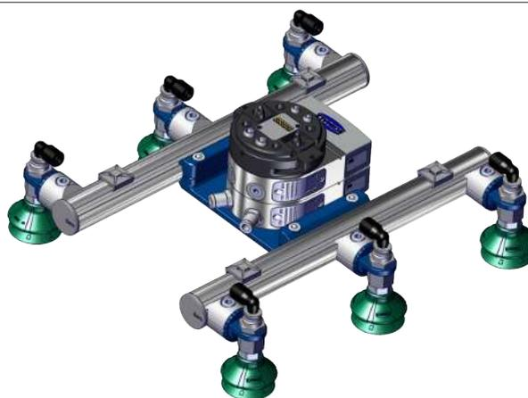
L'alimentation en vide du système de préhension ou des ventouses individuelles est réalisée par l'intermédiaire des raccords de vide du module d'éjecteur ou des modules d'éjecteur au moyen de tuyaux.
