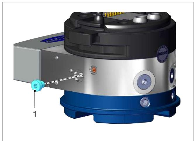
3. Pousser délicatement la buse hors de l'orifice à l'aide d'une broche ou d'une clé à six pans creux.
