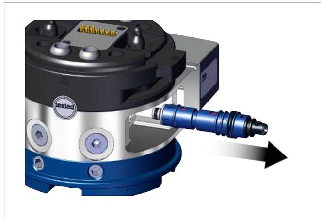
4. Vérifier que tous les joints toriques et les clapets sont présents, correctement montés et légèrement lubrifiés. Enfoncer la nouvelle buse dans le module d'éjecteur en position correcte.
