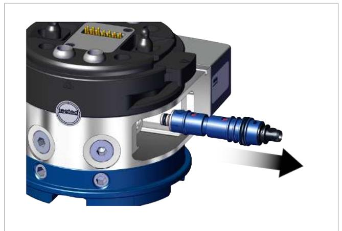
4. Compruebe que todos los anillos toroidales y tapas están presentes, correctamente montados y ligeramente engrasados. Introduzca la tobera nueva en el módulo eyector en la posición adecuada.
