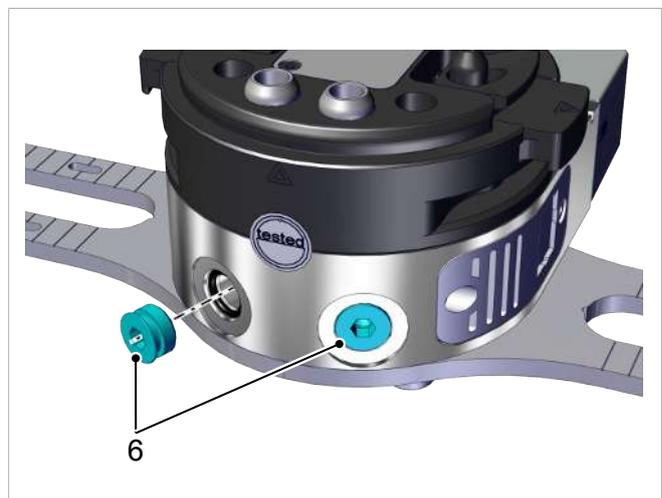
7. In die freien Vakuum-Anschlüsse die Steckverschraubungen (7) einschrauben und mit einem Anzugsmoment von 2,5 Nm befestigen.
