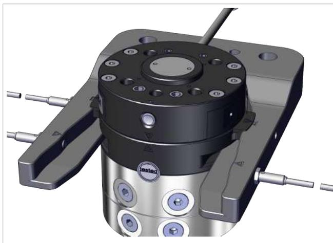
Die Trennung des RMQC Festteils vom RECBI MATCH Losteil findet ebenfalls in der Ablagestation statt. Im RECBI MATCH Losteil sind entsprechende Aussparungen (Nuten) vorgesehen, in die die Gabelzinken der Ablagestation eingreifen. Aufgrund der unterschiedlichen Höhen der Nuten und Gabelzinken ist das Einfahren des RECBI MATCH Losteils in die Ablagestation nur von einer Seite her möglich; bei Nichtbeachtung kann u.U. die Ablagestation beschädigt werden.
