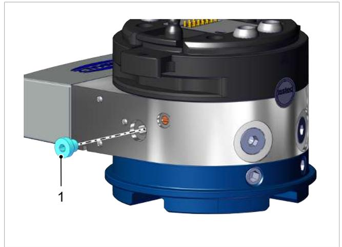
3. Die Düse vorsichtig mit einem Dorn oder einem Innensechskantschlüssel aus der Bohrung schieben.
