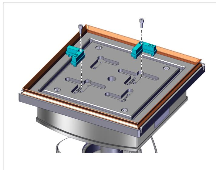
4. Posizionare il bloccaggio meccanico sul piano grigliato. Assicurarsi che nell'ambito del bordi di tenuta si trovi un passaggio per il vuoto del piano grigliato.
