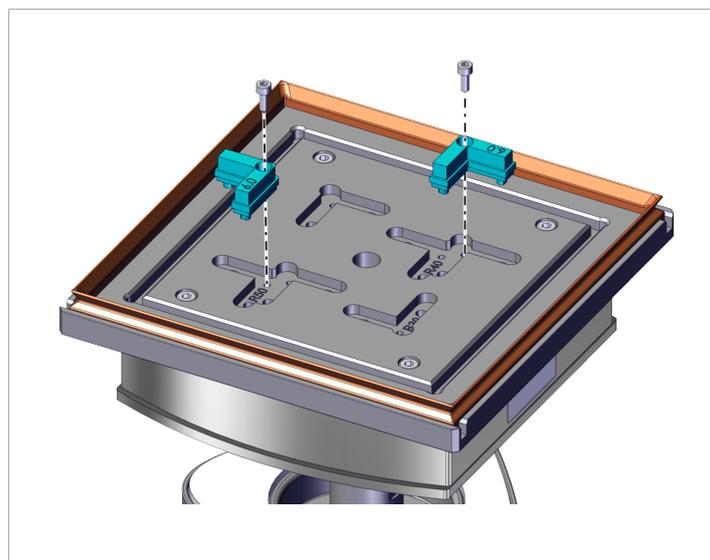
4. Poser le bloc de serrage sur la table quadrillée. Assurer la présence d'un passage de vide ouvert dans la table quadrillée à l'intérieur du cadre d'étanchéité.
