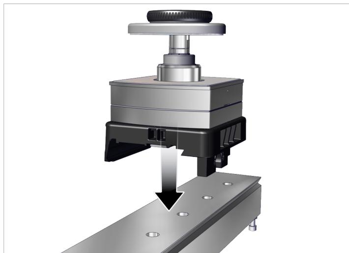
⇒ Il VCMC si inserisce nel profilo di bloccaggio con il vuoto e viene posizionato piatto.
