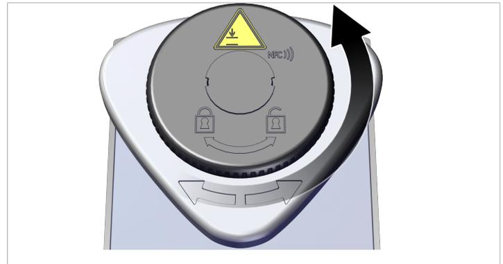
2. **Allentamento del dispositivo di chiusura del posizionamento rapido:** Afferrare il piatto di serraggio con entrambe le mani e spingere e mantenere abbassata di circa 4 mm la manopola.
