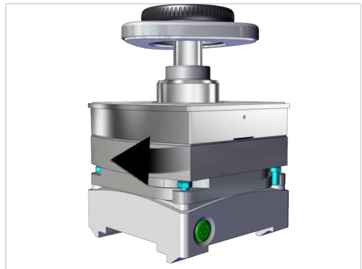
3. Apretar al menos 2 tornillos hexagonales M6 (del tamaño 10) con un par de apriete de 5 Nm.
