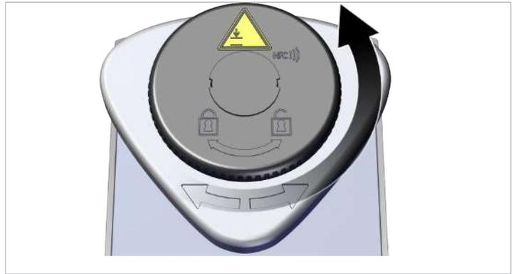
2. **Soltar el bloqueo del ajuste rápido:** coger el plato de fijación con ambas manos y presionar hacia abajo aprox. 4 mm el disco de bloqueo y mantenerlo presionado.
