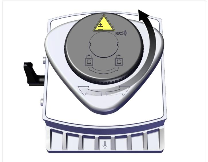
2. **Arretierung der Schnellverstellung lösen:** Den Spannteller mit beiden Händen umgreifen und die Verriegelungsscheibe um etwa 4 mm nach unten drücken und gedrückt halten.
