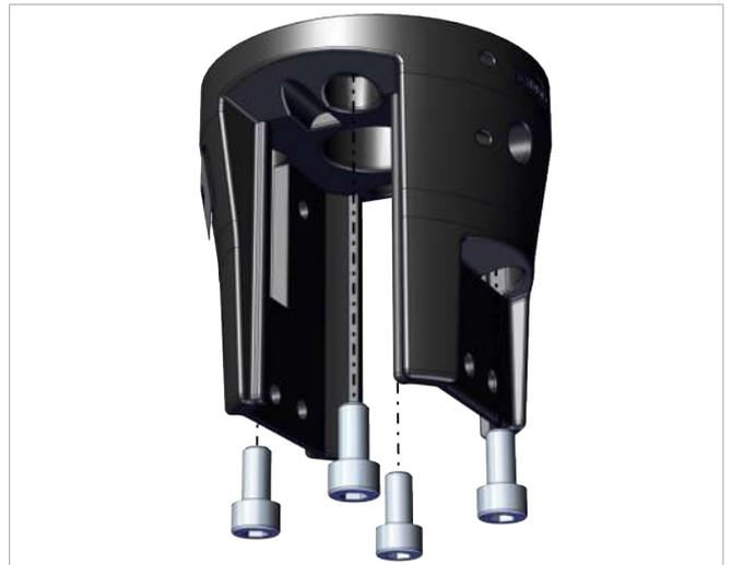
3. Zwei der Schrauben gemäß der Abbildung von Innen in die Aufnahme einlegen **1** und durch die äußere Öffnung das Anzugswerkzeug ansetzen und die Schraube anziehen **2**.
