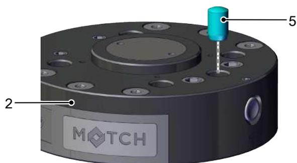
5. Posizionare lentamente la flangia (2) sulla flangia intermedia (1) e riposizionare le viti di montaggio rimosse all'inizio.
