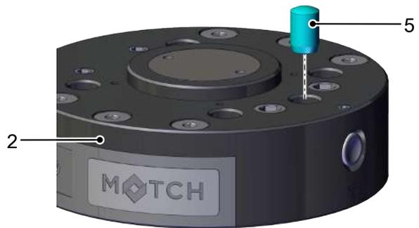
5. Colocar la brida (2) en la posición correcta de la brida intermedia (1) y colocar sin apretar los tornillos de montaje que se desmontaron durante el primer paso.
