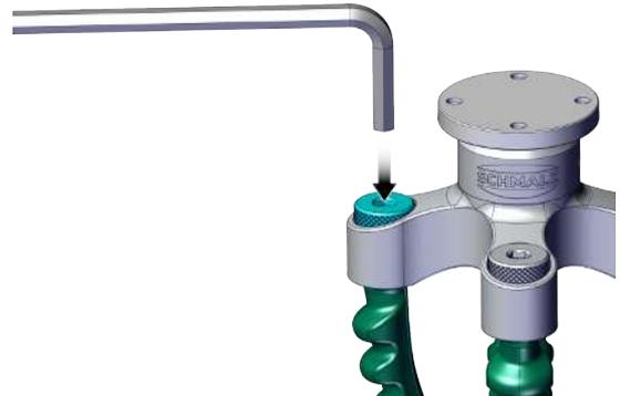
2. Enhebre una llave Allen de tamaño 3 o 4 en un orificio del elemento de sujeción, tal y como se muestra, con el fin de retirarlo o extraerlo con un movimiento de palanca.
