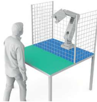
Spazi di lavoro separati
