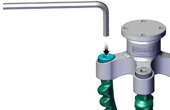
2. Einen Innensechskant-Schlüssel SW 3 od. 4 wie gezeigt in eine Öffnung am Klemmelement einfädeln und das Klemmelement mit einer Hebelbewegung entfernen/herausziehen.
