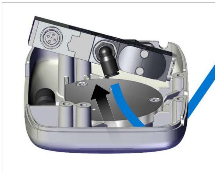
7. Fijar el cable de conexión al eyector compacto, par de apriete máximo = apretado a mano.
