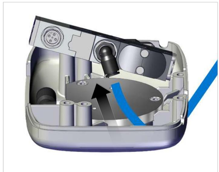
7. Das Anschlusskabel am Kompaktejektor befestigen, maximales Anzugsmoment = handfest.
