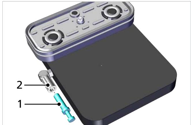
2. Conectar el tubo de vacío de 6 mm de diámetro exterior a la conexión de vacío (2) con un racor instantáneo.
