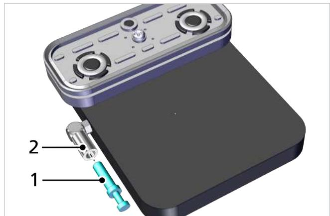
2. Vakuum-Schlauch mit Außendurchmesser 6 mm an dem Schlauch-Anschluss (2) anschließen.
