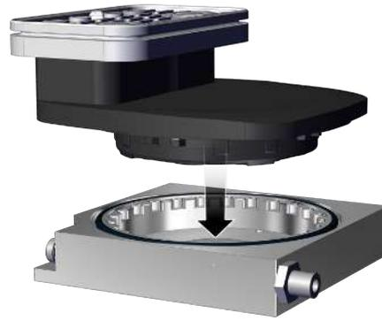
2. Die Adapter-Plate wird mit eingesetztem Sauger, mit dem Reibbelag nach unten auf die Verschleißplatte gesetzt.
