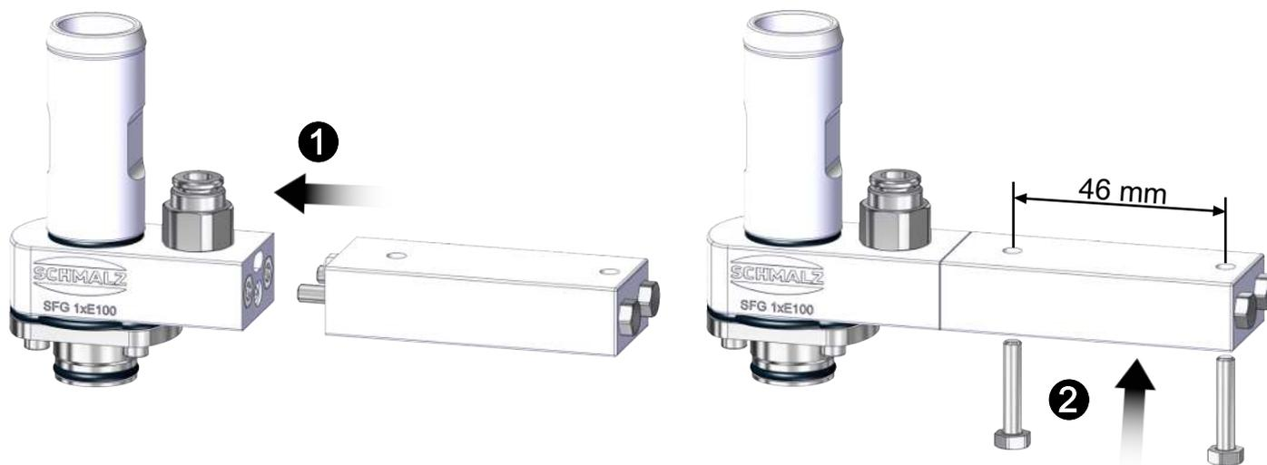
1. Fissare il set di montaggio al SFG. **1**.
