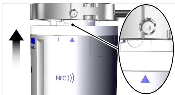
4. Ruotare di 15° ECBPMi (**fino al finecorsa**) in senso orario (la marcatura corrisponde alla tacca della flangia adattatore).
