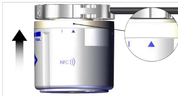
3. Faites pivoter l'ECBPMi de 15° (jusqu'à la butée) dans le sens des aiguilles d'une montre (le repère se superpose à l'encoche de la bride d'adaptation).
