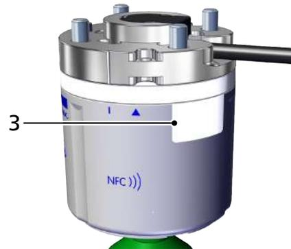
La plaque signalétique (3) est raccordée à demeure au le CobotPump Mini (ci-après dénommé ECBPMi) et doit être toujours bien lisible. Elle contient les mêmes données que la plaque signalétique (2).
