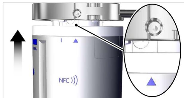
4. Gire el ECBPMi 15° (hasta el tope) en el sentido de las agujas del reloj (la marca de la raya coincide con la muesca de la brida de adaptación).
