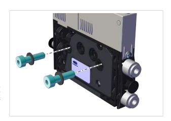
▶ 通过两个直径 4.4 mm 的通孔固定阀门。螺栓的长度 至少达到 20 mm。使用 M4 尺寸的固定螺栓进行安装 时,应使用垫圈。至少使用两颗最大拧紧力矩为 1 Nm 的螺栓固定阀门。
