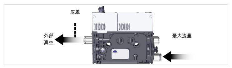
外部真空生成的推荐连接功率为每个打开的吸气回路或每个迷你紧凑型阀门 125 1/min(最多 8 个)。
