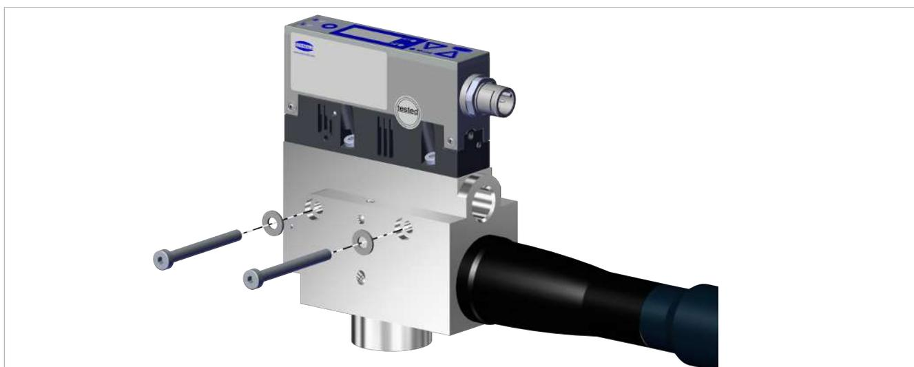
Para el montaje con tornillos de fijación M4, utilice arandelas, con un par de apriete máx. de 2 Nm.
