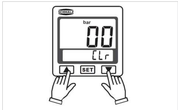
⇒ Sul display inferiore viene visualizzato ELr.
