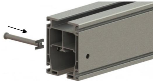
Endanschlag fix STO Bolzen, jeweils beidseitig am Ende von Kranbahn und Kranträger als gesicherter Endanschlag für die Transporthänger.
