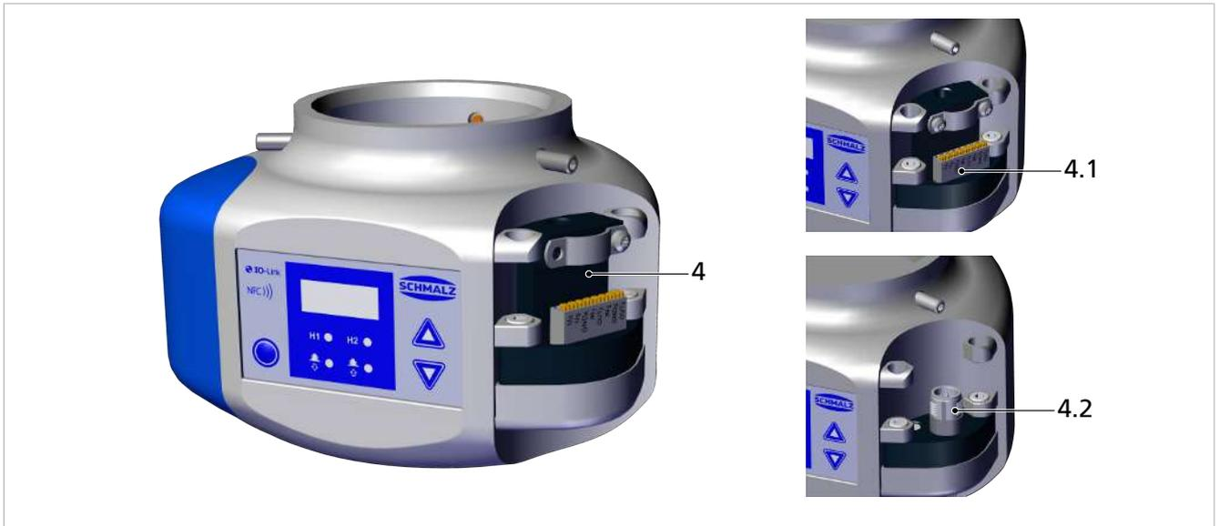
CobotPumpの電氣的接続(電源供給および入力・出力信号の伝送)は、位置(4)のインターフェースを介して行われます。端子ブロック(4.1)または8極M12プラグ(4.2)付のデバイスバージョンを使って柔軟なケーブル接続として実行されます。
