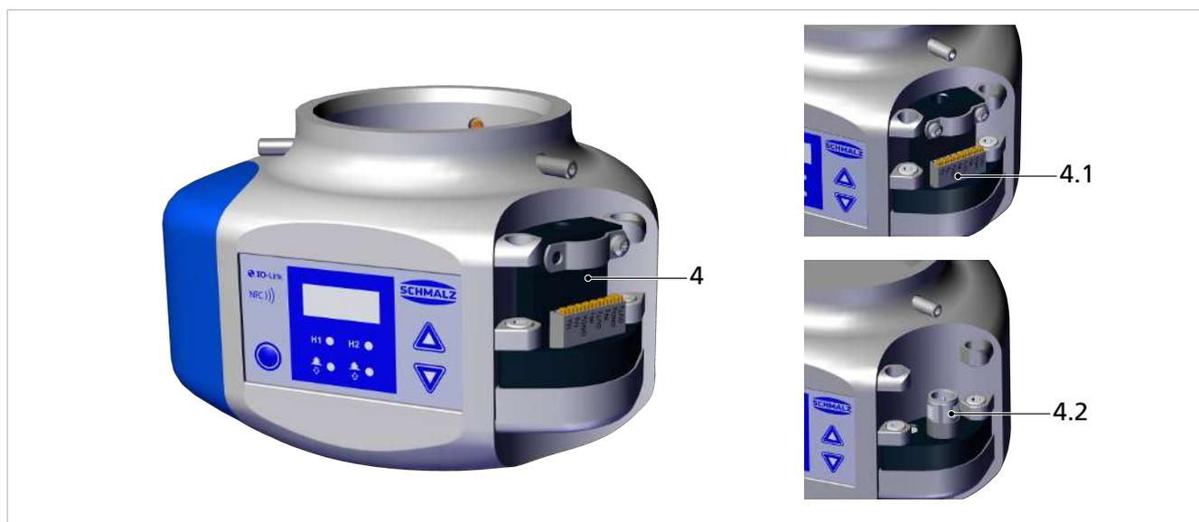
Il collegamento elettrico della CobotPump (alimentazione di tensione e la trasmissione dei segnali d'ingresso e uscita) avviene tramite l'interfaccia alla pos. (4). Può avvenire anche via cavo flessibile per le versioni di dispositivi con morsettiere (4.1) oppure con una spina M12 a 8 poli (4.2).
