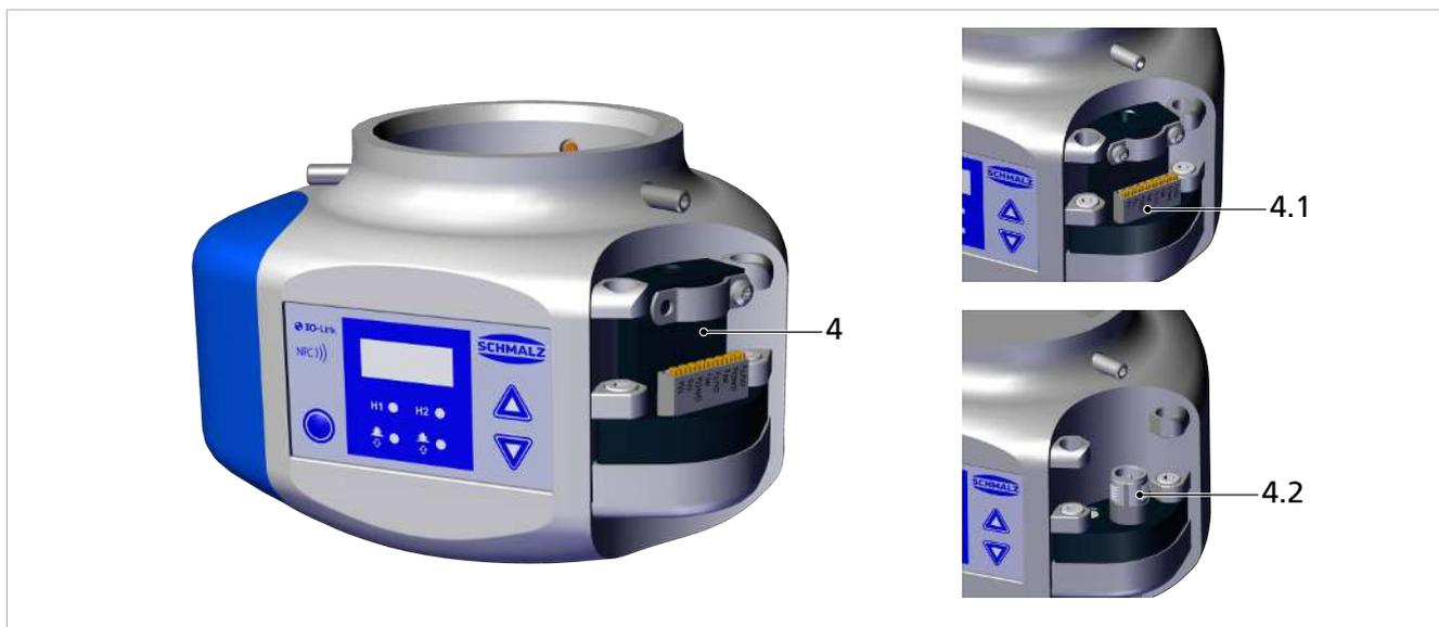
La conexión eléctrica del CobotPump (el suministro de tensión y la transmisión de las señales de entrada y salida) tiene lugar por medio de la interfaz en la pos. (4). Se puede hacer con una conexión por cable flexible a través de versiones del dispositivo con regleta de bornes (4.1) o con un enchufe M12 de 8 polos (4.2).
