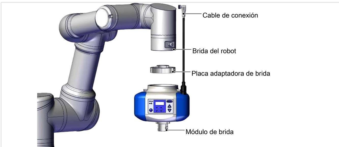
El CobotPump se adapta a un robot colaborativo usando una brida de amarre adaptada intercambiable. Al montarlo hay que respetar las marcas de la brida y la carcasa de CobotPump, que determinan la orientación del indicador y de la ventosa en el robot.
